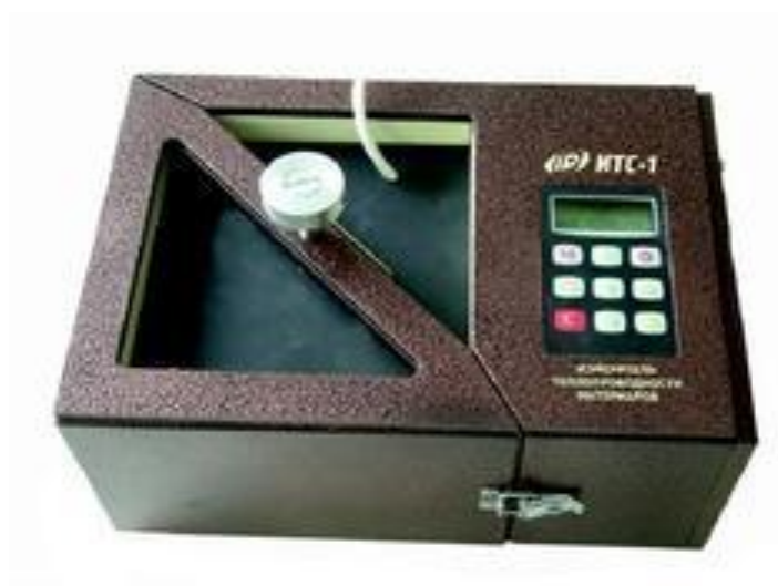
Сурет Г.11 – ИТС-1 стационарлық жылу ағыны әдісімен жылу өткізгіштігін өлшеуге арналған құрал
